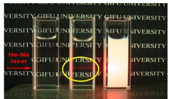
図1 作製したチタン酸水溶液 左から、純水、チタン酸水溶液、 \text{TiO}_2 ゾル
